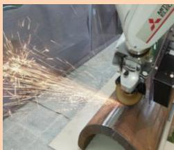
研削ロボットのシステム開発。研削に最適なロボットの制御システムを構築するため、様々な条件設定を試験。
